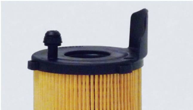
Resim 3: Sahte ürünün kılıcı: Belki bu şekilde MAHLE patenti ihlâl edilmiyor, ancak motordaki baypas valfi zarar görüyor!
