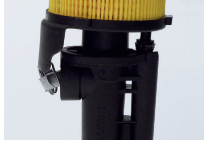
Resim 4: Bağıntılı hasar görmüş baypas valfinin ayrıntılı görüntüsü.
